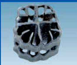
Aufwuchskörper Mit einer biologisch aktiven Oberfläche von 400 m 2 / m 3 . Perfekt abgestimmt auf den Einsatz in Kleinkläranlagen.
