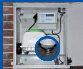
Wandhalterung (Serie) zur Außen- und Innenaufstellung mit Steuereinheit , netzunabhängiger Stromausfallerkennung (NUSA), energieoptimiertem Verdichter (80l/min) bis zu einer Wassertiefe der Kleinkläranlage von 1,60 m , Maße (B,H,T) 396x520x245 mm. Innenansicht mit serienmäßig schwingungsgedämpften Gerätefüßen des Membranverdichters.
